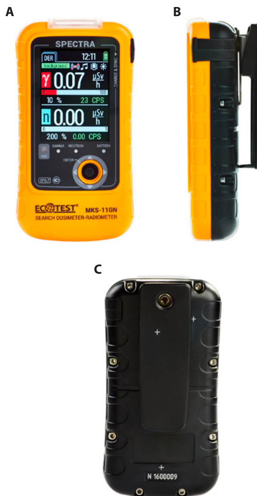
Fot. 2. A – widok z przodu, B – z boku i C – z tyłu radiometru MKS-11GN Spectra. Znaki „+” z tyłu obudowy odpowiadają geometrycznemu środkowi poszczególnych detektorów
