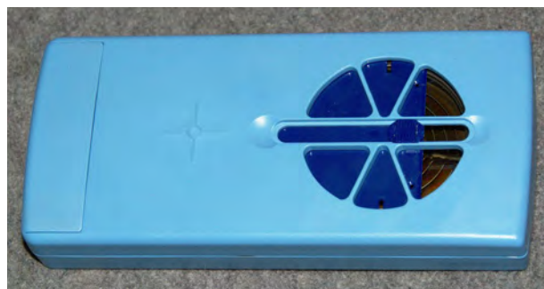
Fot. 5. Dozymetr Radex RD1008 — z lewej zaznaczony środek licznika promieniowania gamma typu Beta-2M, z prawej licznik promieniowania alfa i beta typu Beta-2 z częściowo uchyloną osłoną Photo 5. Radex RD1008 dosimeter — Beta-2M type gamma radiation counter with a partially opened cover on the right
